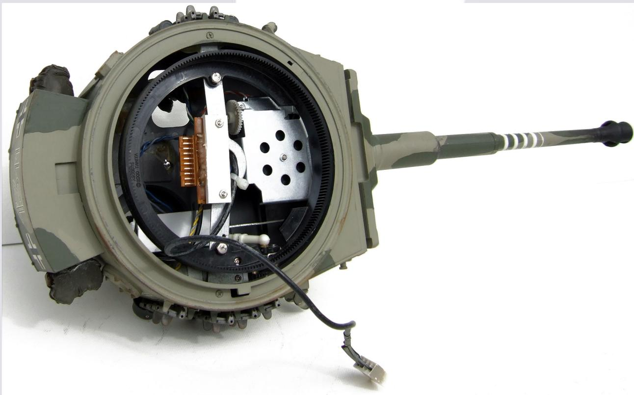
**Bild 1:** nur noch zwei Kabel müssen für FO und die zusätzlichen Funktionen mit dem Turm verbunden werden
